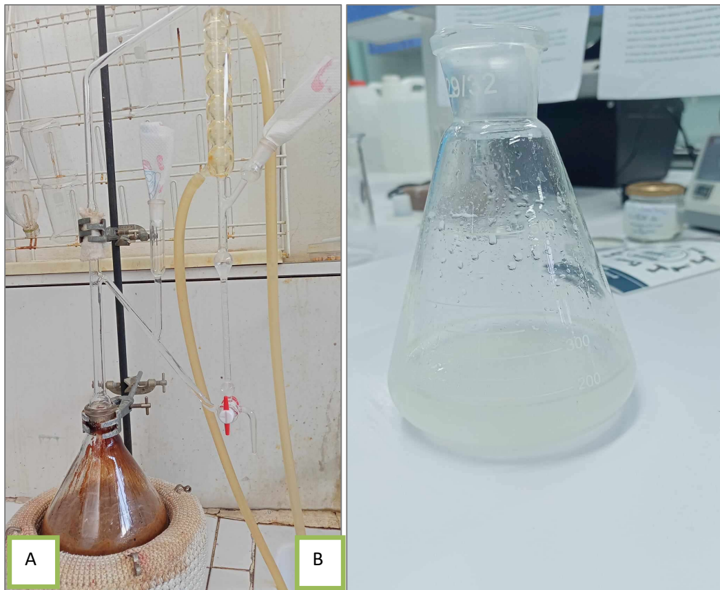
Figure 14 : A. Extraction de l'huile essentielle du clou de girofle par hydro distillation (originale). B. Le distillat récupéré après 3h d'hydro-distillation.
